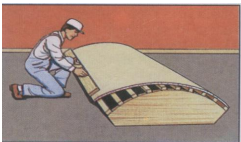
76 pav. Drėgnos plokštės lenkimas ant šablono
