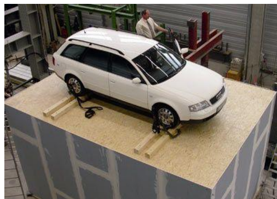
26 pav. Cubo Empore sistema. Ant lubų sumontuota gipso plaušo sausos grindys
