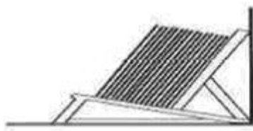
74 pav. OSB laikymas ant šono
