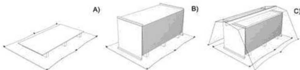
25 pav. OSB plokščių sandėliavimas
