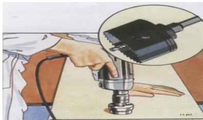
65 pav. Angų pjovimas plokštėje žiediniu grąžtu
