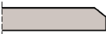
3 pav. FK briauna. Stati nusklembta briauna.
