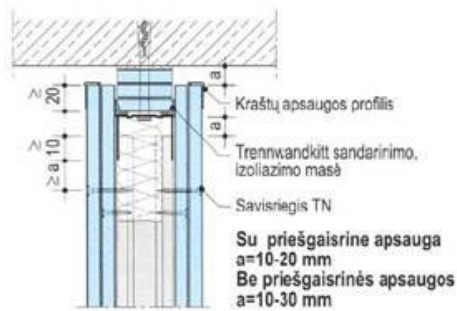
11 pav. Slankioji jungtis esant priešgaisriniams ir garso izoliacijos reikalavimams W11
