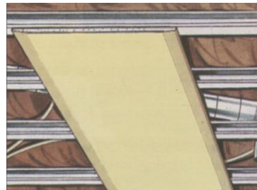
50 pav. Plokščių tvirtinimas skersai laikančiosios konstrukcijos elementų
